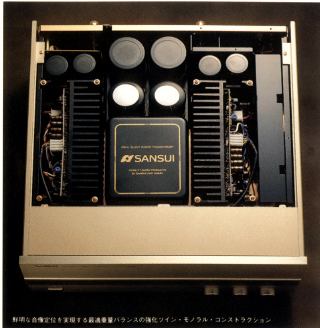
鮮明な音像定位を実現する最適重量バランスの強化ツイン・モノラル・コンストラクション
